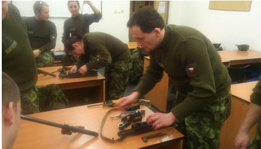
Obr. 2 Sborka a rozborka kulometu vz. 59. 6
