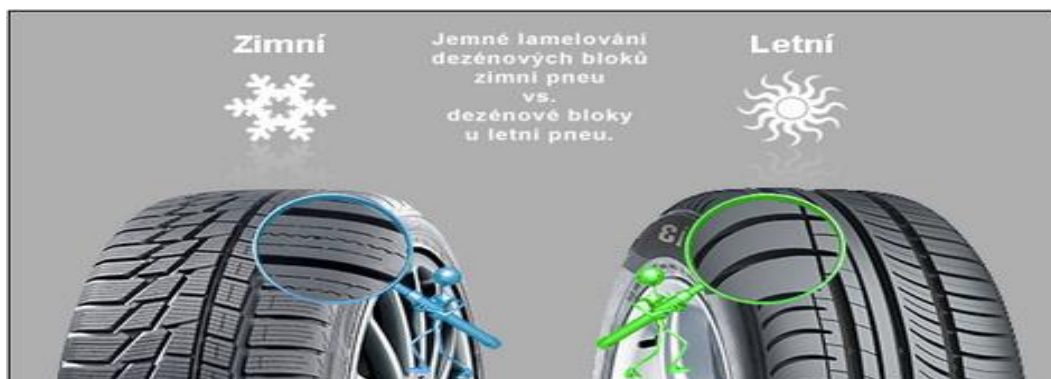
Obr. 21. Ukázka jemného lamelování zimních pneu oproti letním [28].
