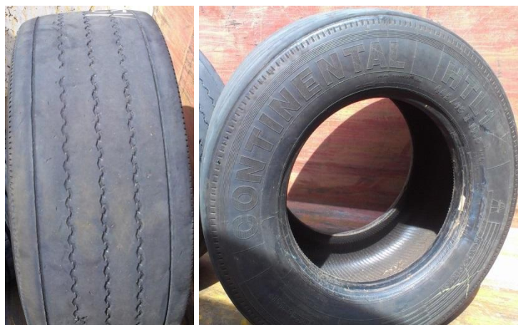
Obr. 32. Ukázka sjetého dezénu – pneu Continental, letní směs (445/45R19,5).
