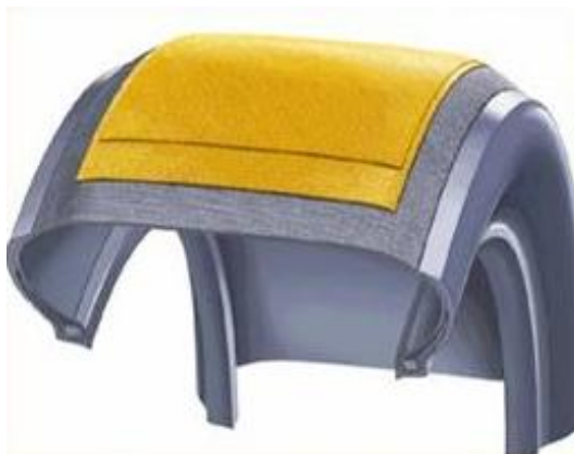
Obr. 8. Korunní kordová vrstva (nárazník) [15].
