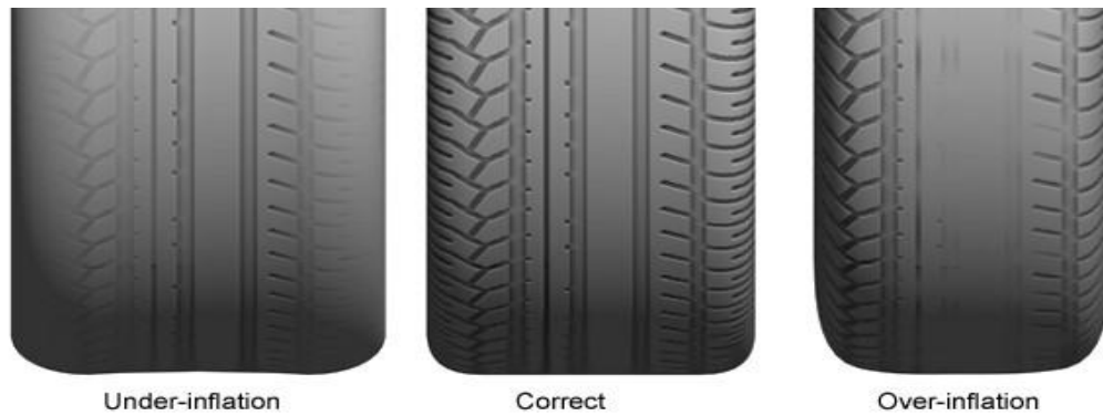
Obr. 17. Způsob ojetí dezénu při podhuštění a přehuštění pneumatiky [15].
