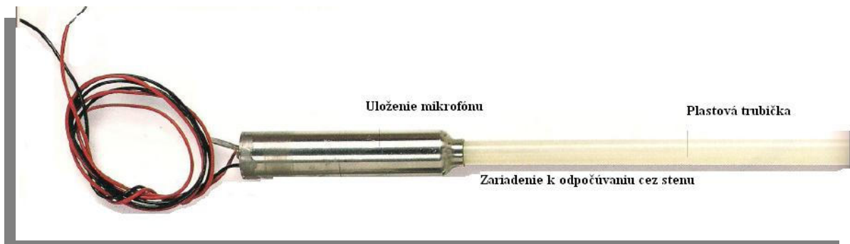
Obrázok 28, Zariadenie k odpočúvaniu cez stenu. [6]
