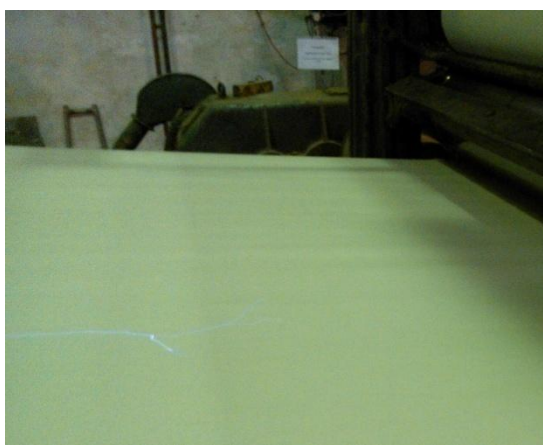
Obr. 26. Elektrostatický výboj při výrobě lepenky o plošné hmotnosti 330 g/m 2
