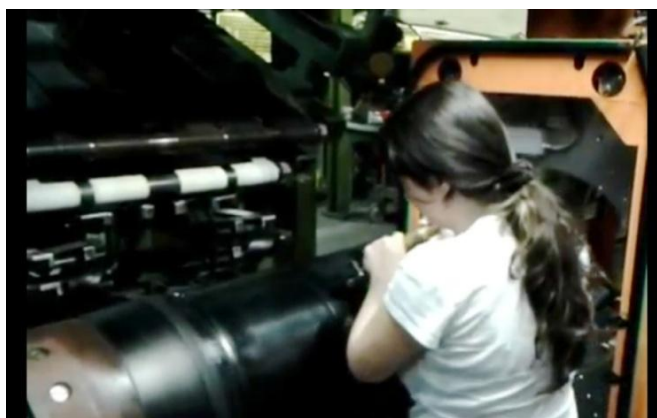
Obrázek 14: První stupeň konfekce ve výrobě – navinutí vnitřní gumy a zafixování spoje rádlem
