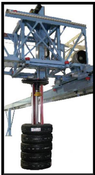
Obrázek 27: Pojízdné rameno pro přepravu pneumatik ze skladu na pásový dopravník
