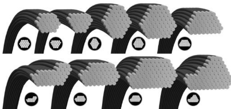
Obrázek 10: Způsoby tvarování patních lan
