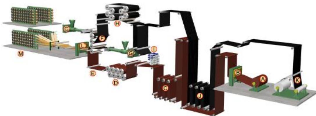
Obrázek 7: Linka pro oboustranné nánosování na textilní i ocelový kord - Odvíjecí stanice textilního kordu, Parní spojovací lis textilního kordu, Kompenzační zásobník surového textilního kordu, Sušička textilního kordu, Středící a napínací zařízení. Nánosový pětiválec, Ohřívací a zásobovací extrudéry, Chladicí zařízení, Pokládání odvodušňovacích nití, Zásobník pogumovaného kordu, Navíjecí stanice, Parní spojovací lis ocelového kordu, Cívečnice ocelových lanek
