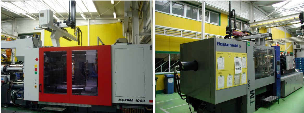
Obr. 13: Lis Ferromatik Milacron s přtlakem 1000 t (Lisovna plastů, 2012) Obr. 14: Lis Battenfeld (Lisovna plastů, 2012)
