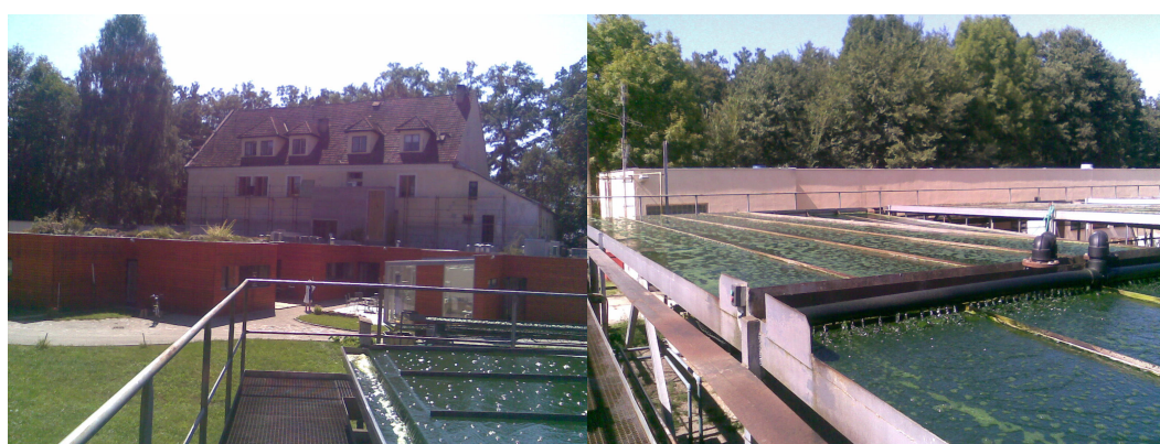
Obr. 3: Venkovní otevřené kultivační zařízení na tenké vrstvě s kaskádovitým uspořádáním pro kultivaci mikrořas v areálu Opatovického mlýna v Třeboni
