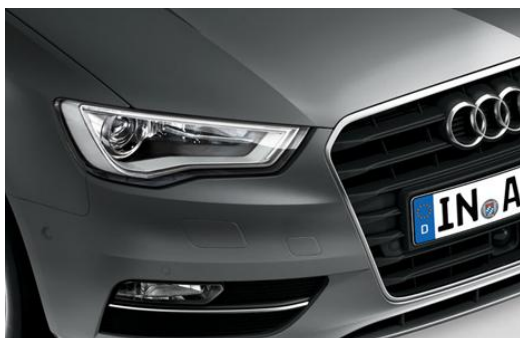
Obrázek 28: Pravý 4 přední světlomet Audi A3 – xenon (Hella Autotechnik, s. r. o., 2013)
