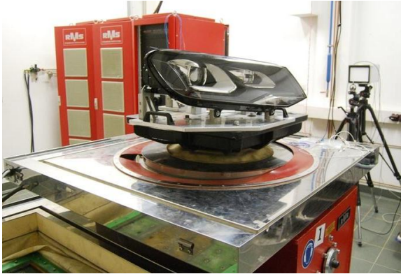
Obrázek 33: Testování na vibračních deskách (Hella Autetechnik, s.r.o., 2012)
