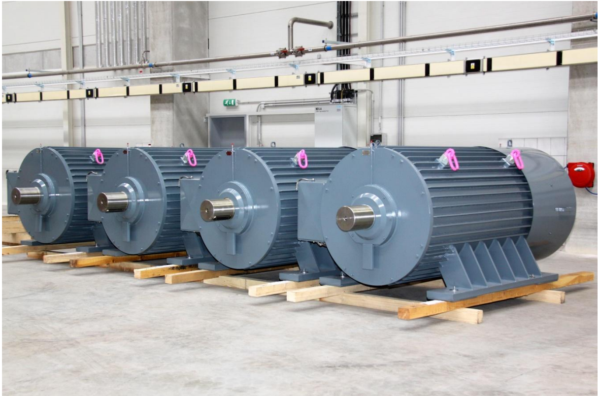
Obr. 11 Horizontální generátory připravené k expedici (Zdroj: vlastní zpracování)
