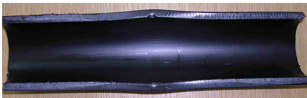
Obr. 58. Trvalá deformace půl-trubkového profilu
