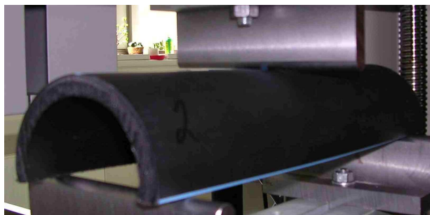
Obr. 53. Deformace profilu nahoru při y=1 mm
