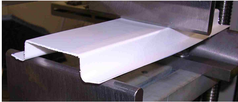
Obr. 32. Deformace u-profilu nahoru při y=1\text{mm}
