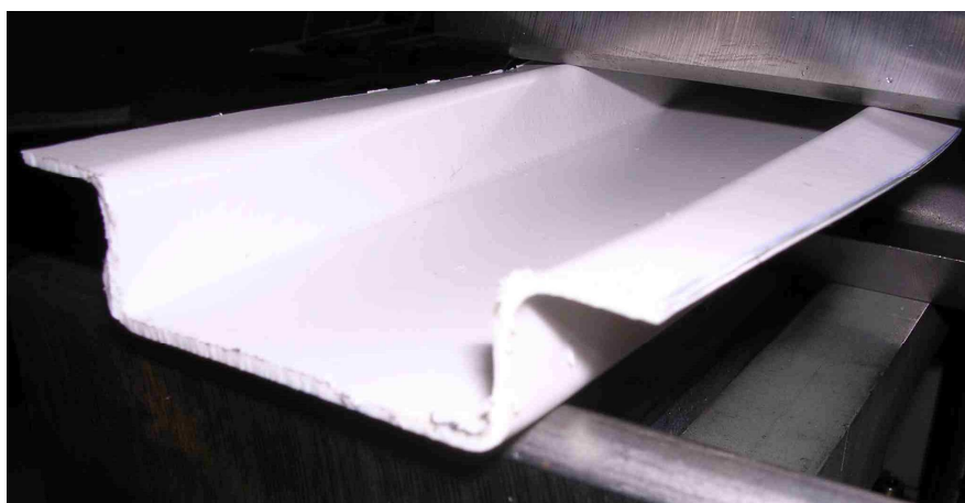
Obr. 36. Deformace u-profilu dolů při y=4\text{mm}
