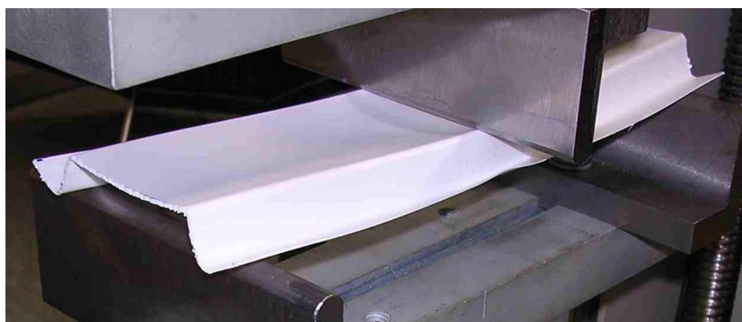
Obr. 34. Deformace u-profilu nahoru při R_m
