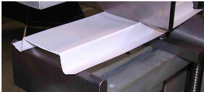
Obr. 33. Deformace u-profilu nahoru při y=4\text{mm}
