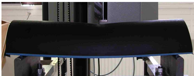
Obr. 54. Deformace profilu nahoru při y=5 mm
