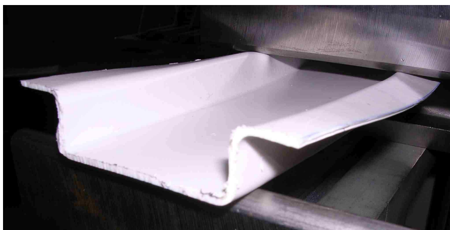
Obr. 37. Deformace u-profilu dolů při R_m
