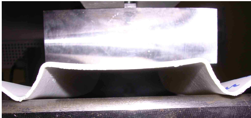
Obr. 39. Ztráta stability profilu
