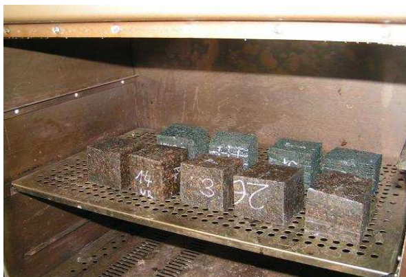
Obr. 24. Ohřev prouděním v horkovzdušné komoře
