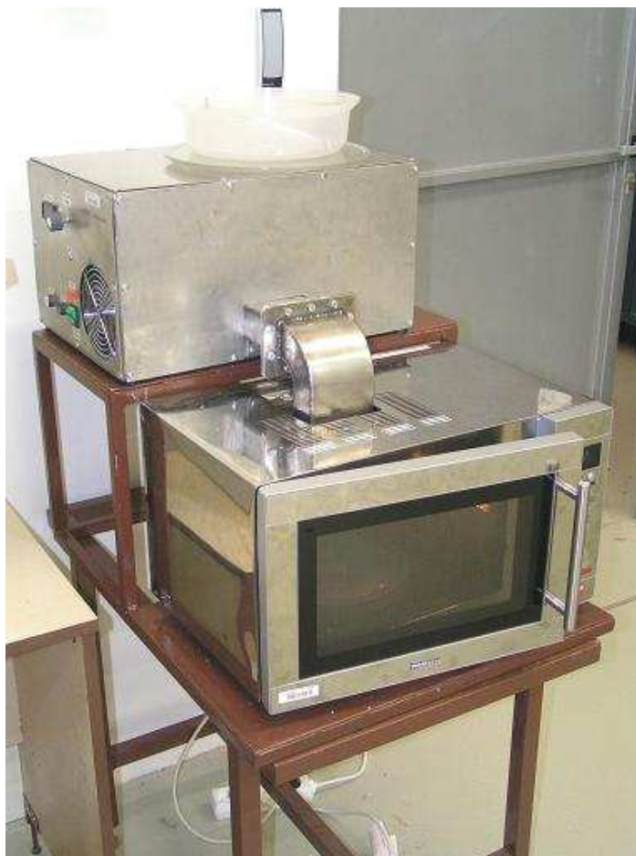
Obr. 16. Zařízení pro mikrovlnný ohřev(k horní části zařízení Professor MTE-235 BX je připojen další zdroj mikrovln Romill)
