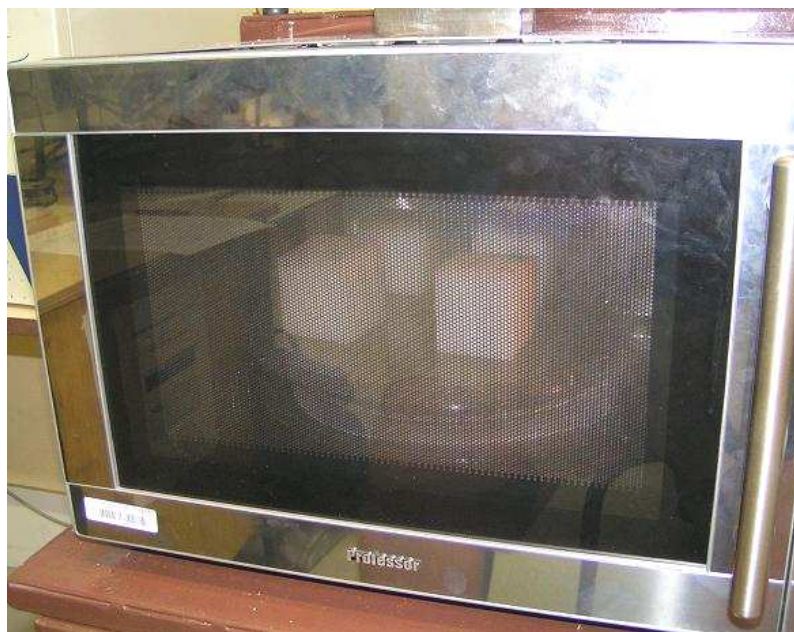
Obr. 20. Ukázka ohřevu kaučuků v MW zařízení
