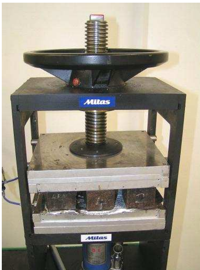
Obr. 22. Ohřev vedením ve vulkanizačním lisu
