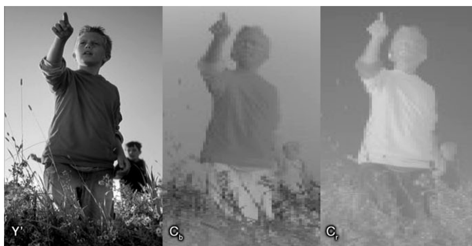
Obr. 16. Rozdělené barevné složky při vzorkování 4:1:1
