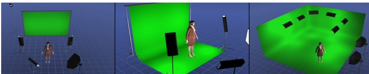
Obr. 19 - Tvary klíčovacího pozadí zleva: Backdrop, Cyclorama, Cyclorama v rohu místnosti
