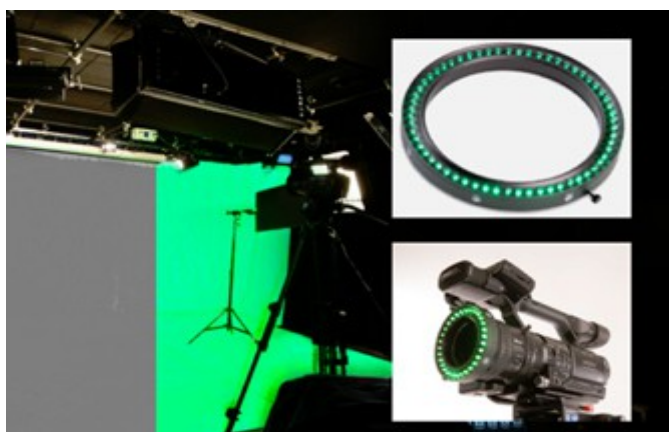
Obr. 18 - Ukázka systému Reflecmedia, Zleva: nenasvícené a nasvícené pozadí Chromatte, LiteRing a jeho umístění na kameře
