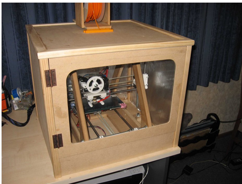
Obr. 36: Tiskárna Prusa–Mendel zakrytovaná MDF deskami
