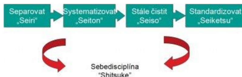
Obr. 3: Schéma 5S (API - Akademie produktivity a inovací, s.r.o., ©2005 – 2012)
