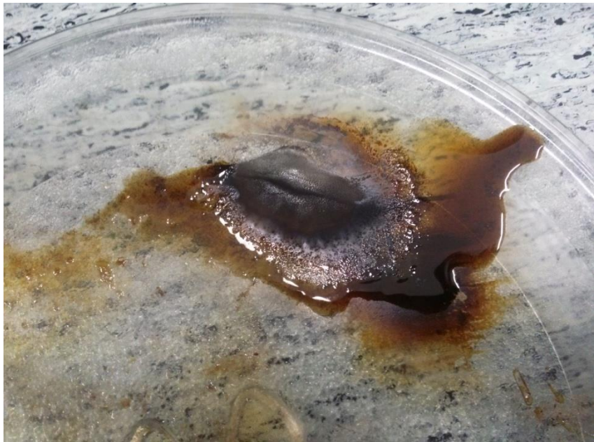
Obr. 40 Ohořelý olej ze SIR 20 SED
