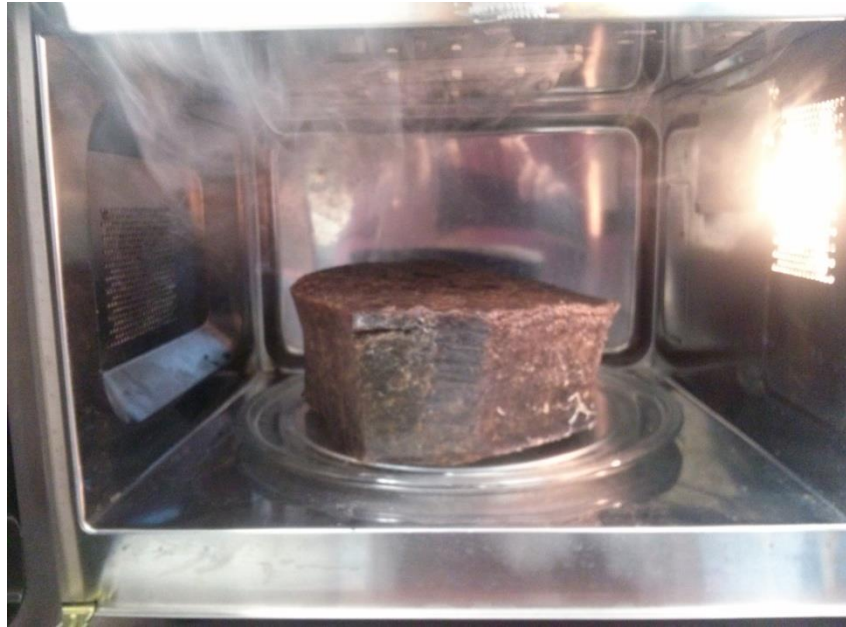
Obr. 39 Zahoření oleje po 5 minutách ohřevu
