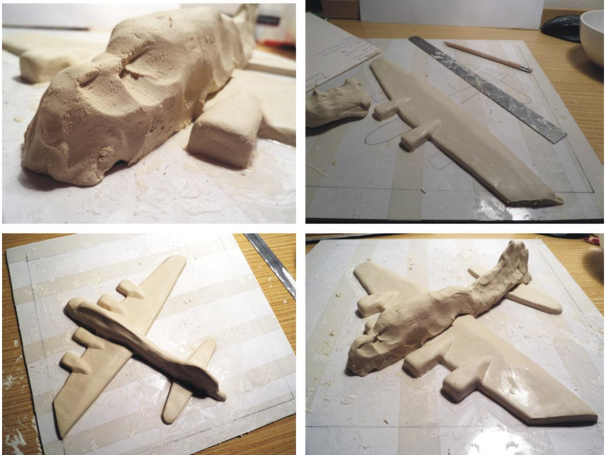
Obr. 53. Negativní forma letadla (měřítko 1:5)
