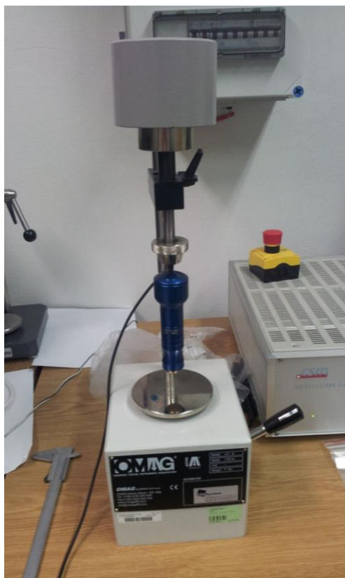
Obr.7 OMAG Affri ART 13 s výměnnými sondami
