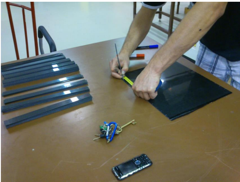
Obrázek 31-Měření a následné dělení kompozitového plátu na jednotlivá zkušební tělesa.
