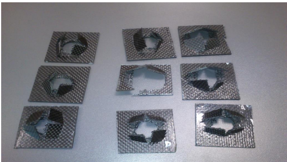
Obrázek 47-Zkušební tělesa po zkoušce víceosým rázovým namáháním.
