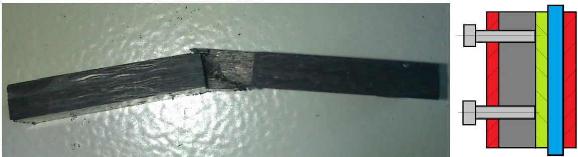
Obrázek 43-Zkušební těleso po zkoušce tlakem, vpravo zkušební přípravek (tělo přípravku čtvercového průřezu, opěrná deska, karbonové zkušební těleso, šroub M5)
