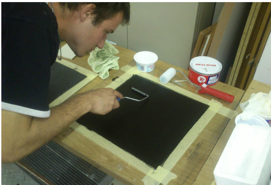
Obrázek 29- Výroba karbonové desky technologií ručního laminování.
