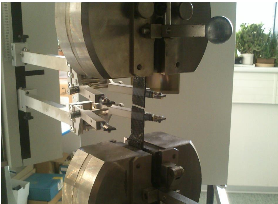
Obrázek 41- Zkouška tahem v okamžiku roztržení zkušebního tělesa.
