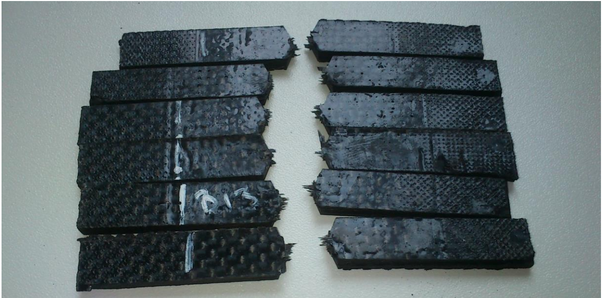
Obrázek 46- Zkušební tělesa po Zkoušce rázové houževnatosti v tahu.
