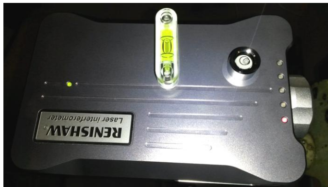
Obr. 21 Vyrovnání laseru vodováhou
