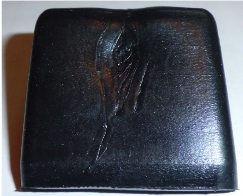
Obr. 47 Ukázka napáleniny na pryžovém výrobku
