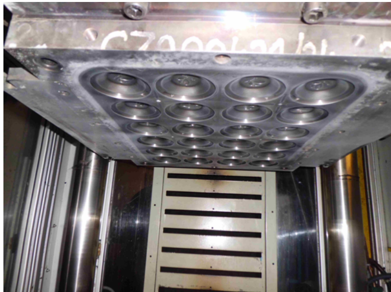
Obr. 44 Horní deska formy na těsnící krytky
