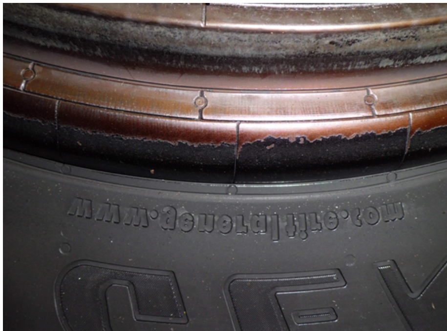
Obr. 30 Detail znečištěné formy
