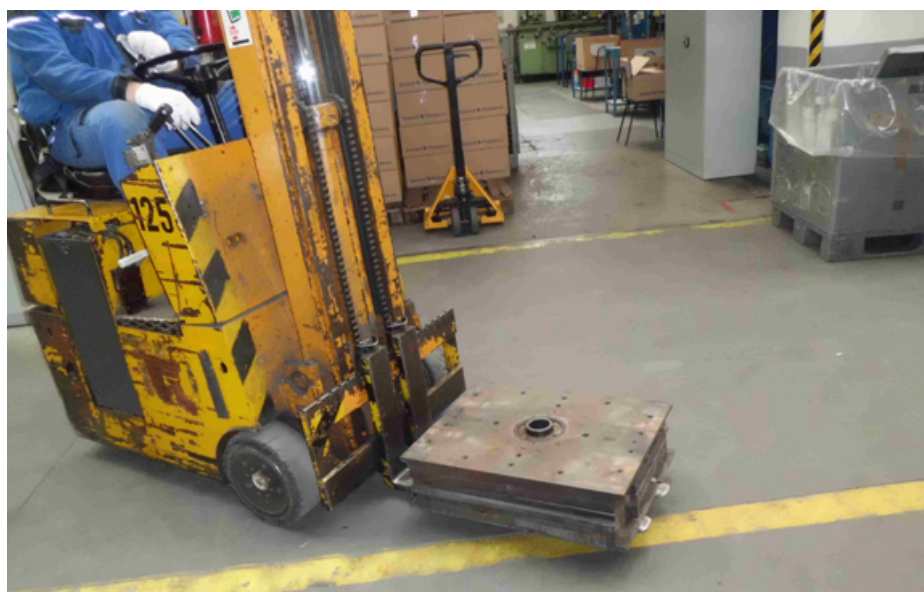
Obr. 46 Přeprava formy do tryskacího zařízení
