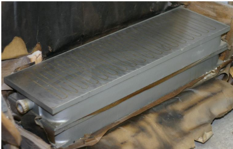
Obr. 21. Elektromagnetická deska pro brusky [1]
