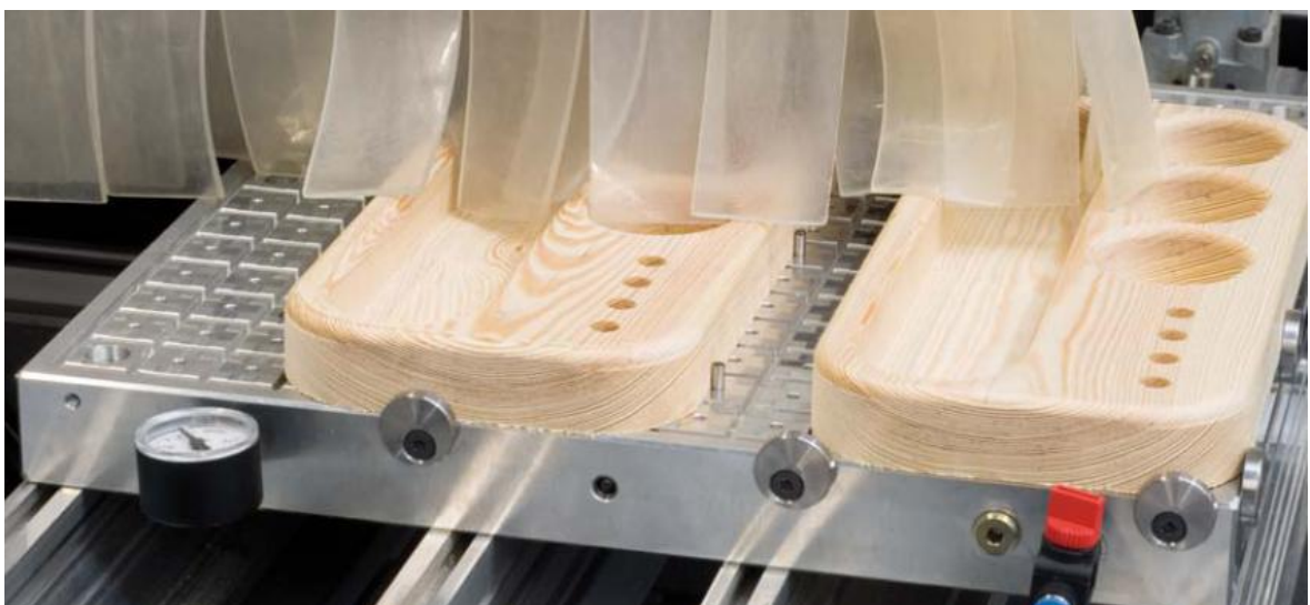
Obr. 22. Vakuová upínací deska [1]
