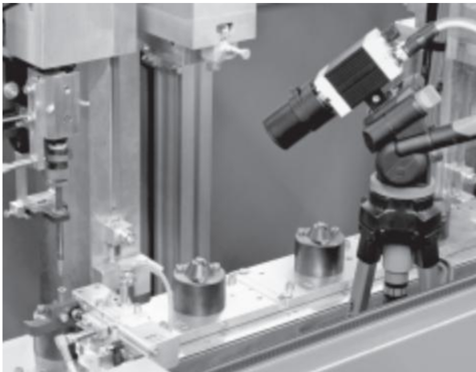
Obr. 36. Kontrola orientace pomocí kamery [3]
