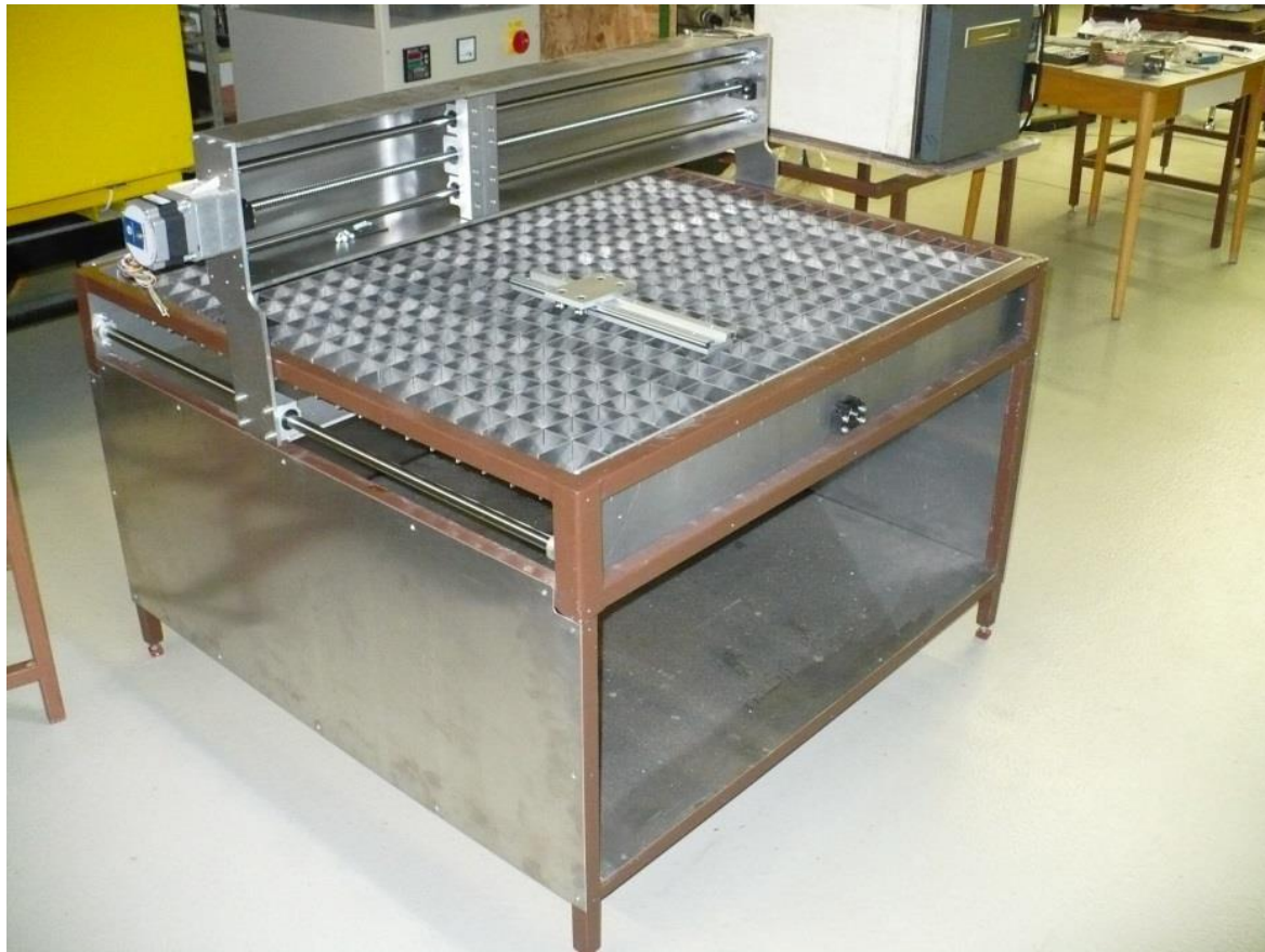
Obr. 40. Vývoj zařízení plazmového řezacího stroje
