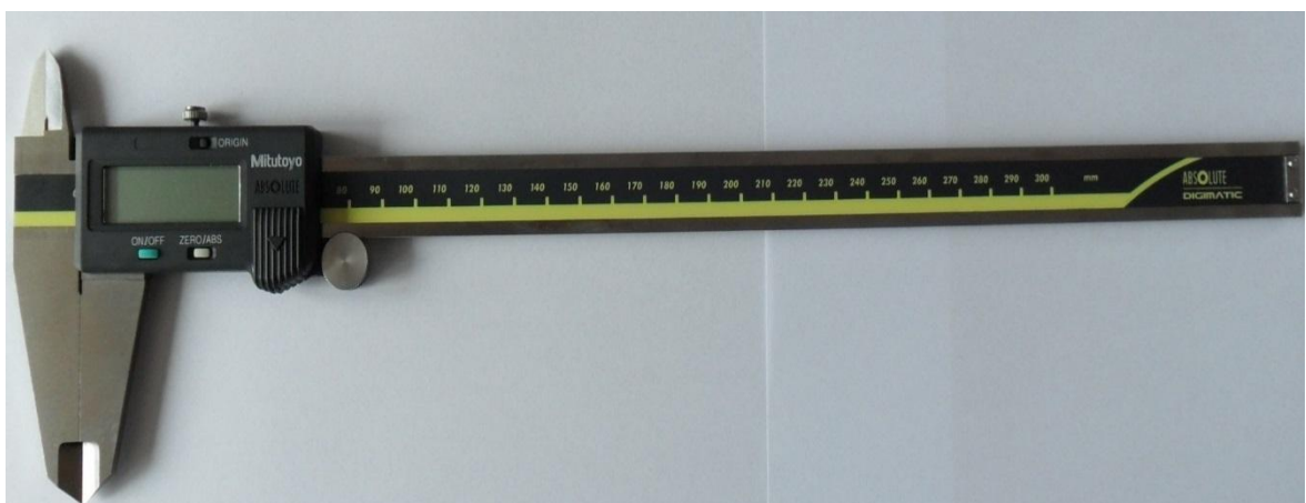
Obr. 12. Posuvka (měřicí rozsah 0-300mm)
