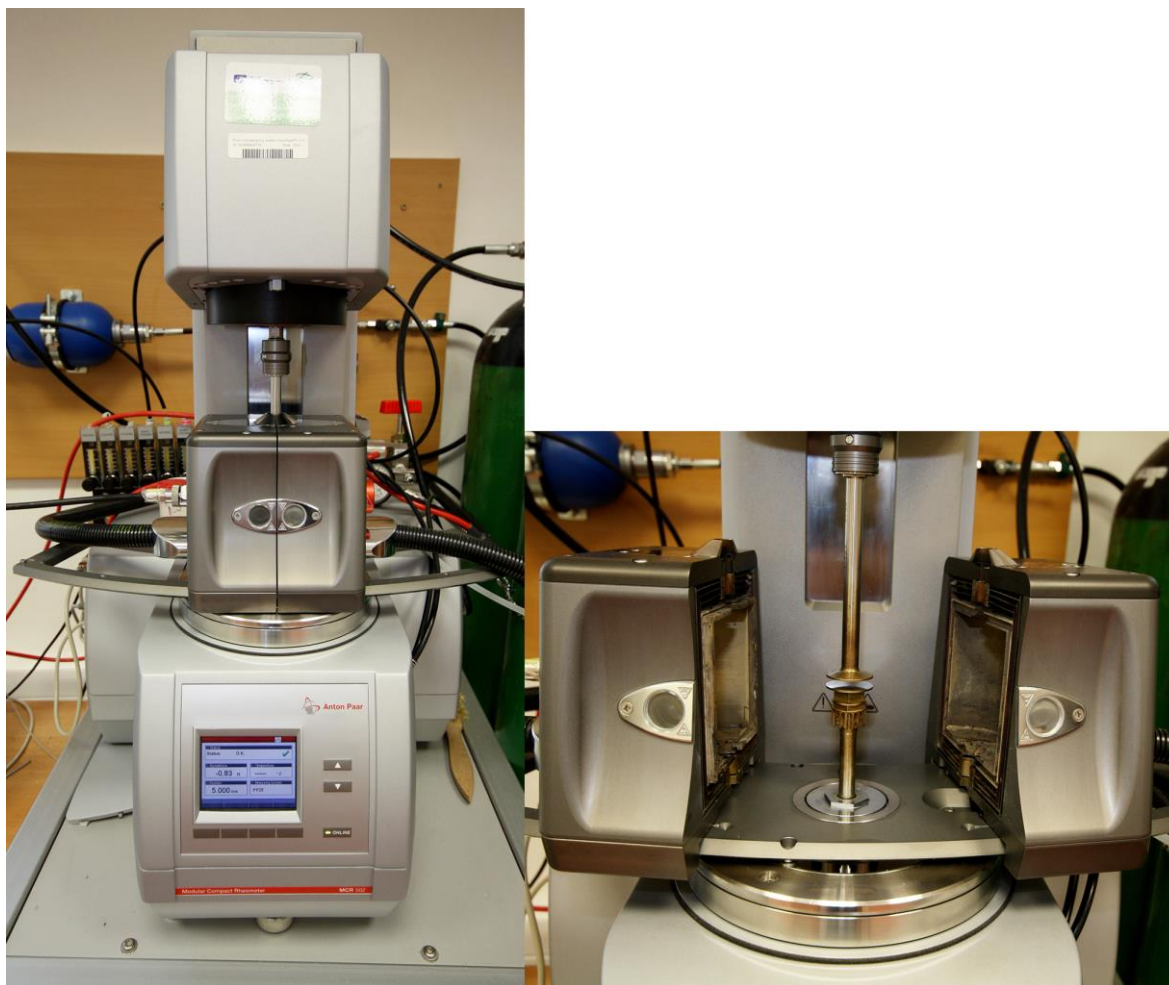
Obr. 26 Rotační reometr Anton Paar MCR 502 – celkový pohled (vlevo), detail měřící cely (vpravo)
