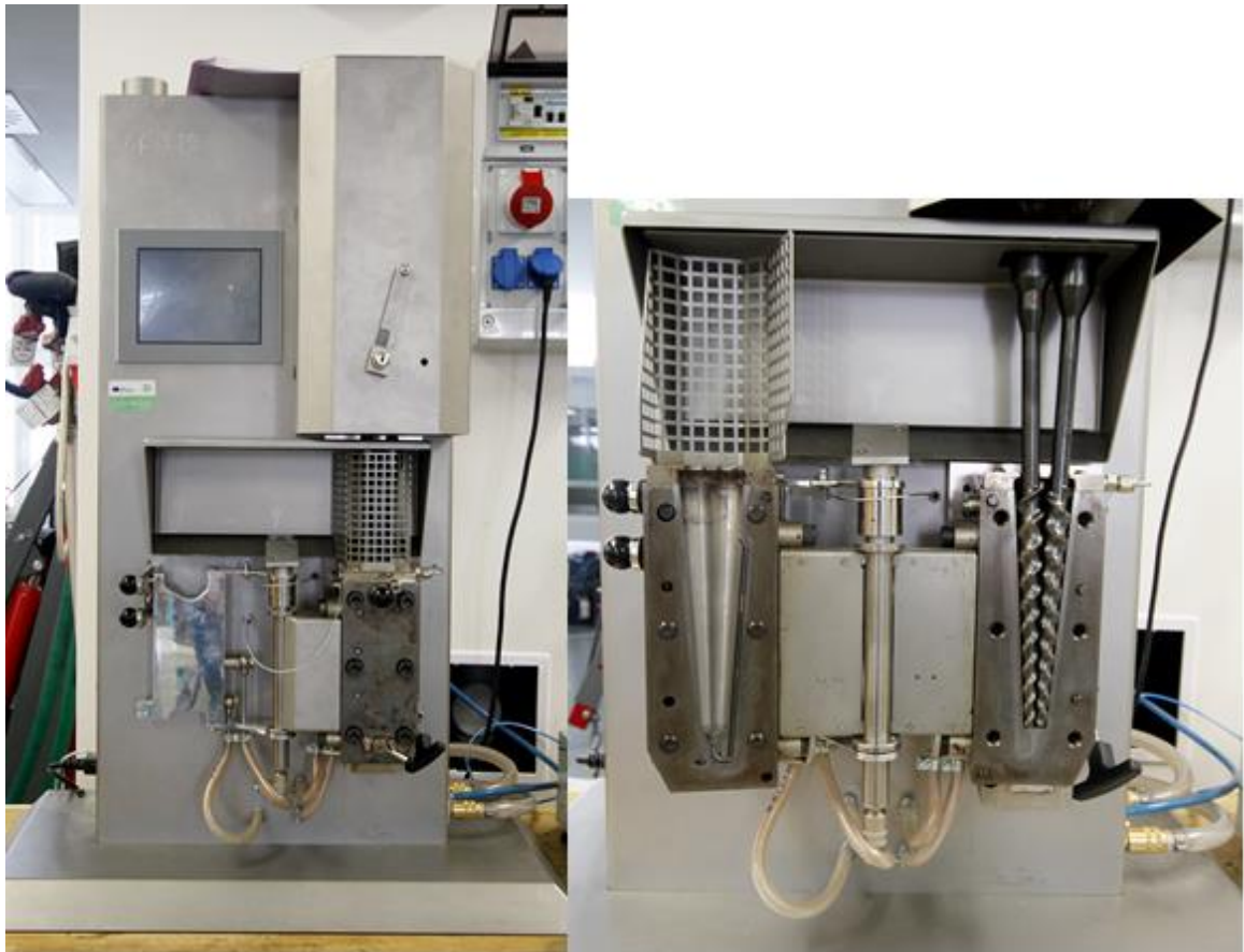
Obr. 28 Mikrohnětič DSM Xplores 5&15 Micro compounder – celkový pohled (vlevo), detail míchací komory se šneky (vpravo)
