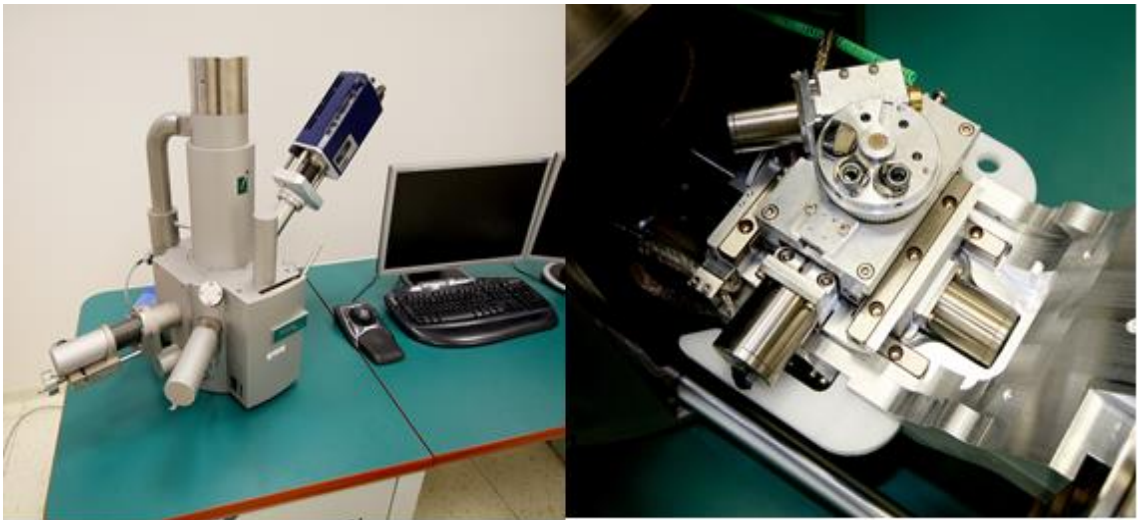
Obr. 29 Skenovací elektronový mikroskop Vega Tescan LMU II – celkový pohled (vlevo), detail měřícího prostoru (vpravo)
