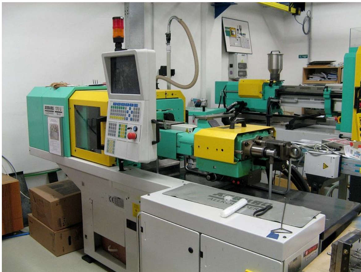
Obr. 24. Vstřikovací stroj ARBURG Allrounder 170 U – v popředí
