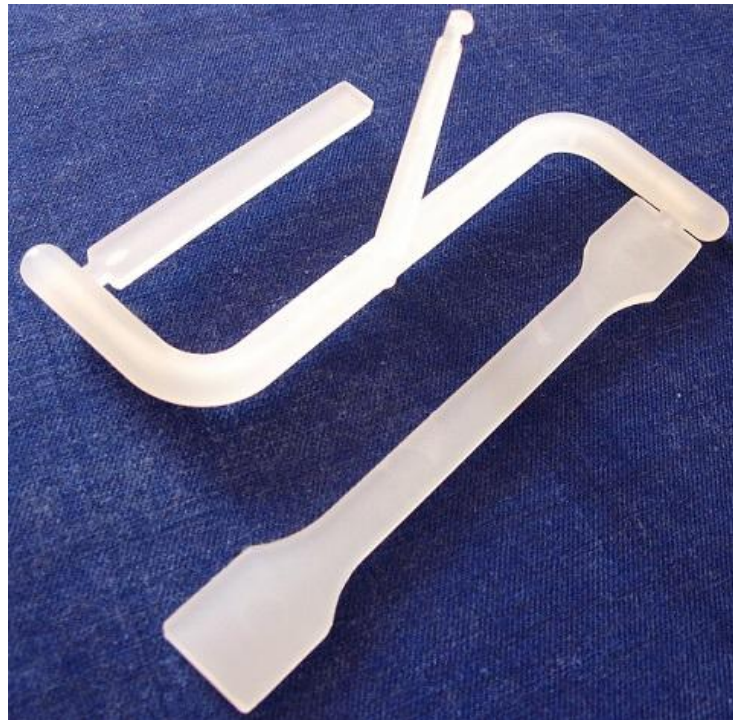
Obr. 22. Vpravo zkušební těleso pro statickou zkoušku v tahu
