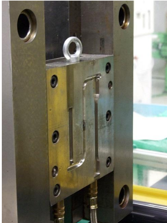
Obr. 23. Vstřikovací forma ve vstřikovacím stroji ARBURG Allrounder 420 C
