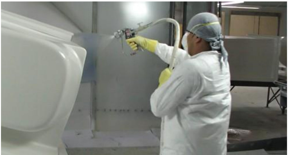
Obrázek 7 Nanášení gelcoatu pomocí stříkací pistole.
