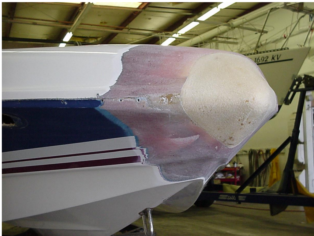
Obrázek 6 Opravená část lodě bez povrchové vrstvy – gelcoatu.[117]
