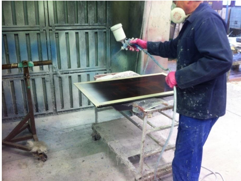
Obrázek 16 Nanášení vrstvy gelcoatu na povrch formy-vzorek C.
