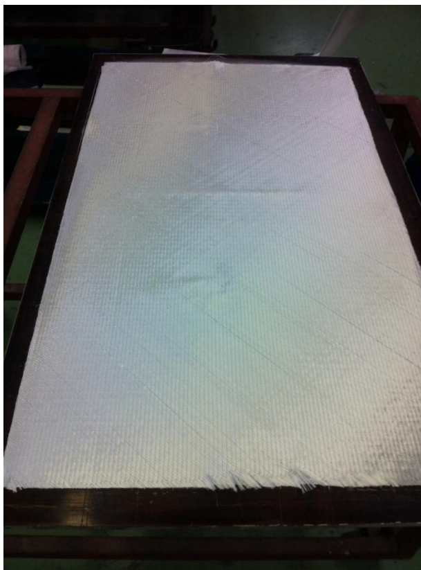
Obrázek 17 Pokládání vrstev výztuže.
