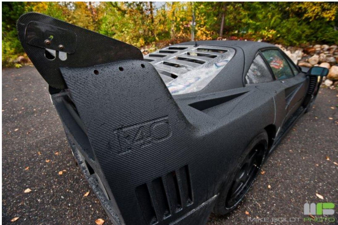
Obrázek 2 Přítlačné křídlo Ferrari F40 – vyrobeno z karbonových vláken.[4]
