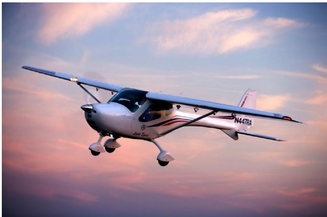
Obrázek 3 Sportovní letadlo, které je z velké části vyrobeno z kompozitních materiálů.[5]
