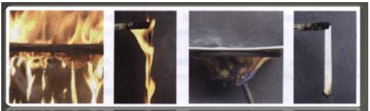
Obrázek 11 Rozdíl mezi neplněným PP a Nanoblendem při působení plamene po dobu 120sekund.[10]
