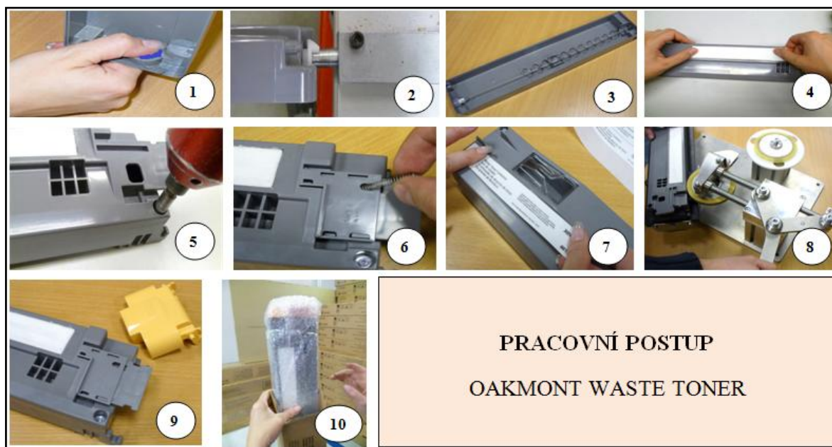
Obr. 29 Pracovní postup montáže výrobku Oakmont Waste Toner (Zpracováno dle: vnitropodnikové materiály)
