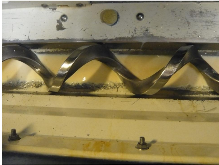
Obr. 6 Zanesený žlab stroje (vlastní)
