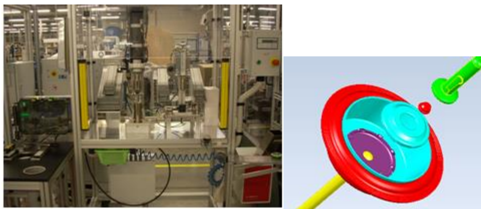
Obr. 24 Lisovací stroje se dvěma lisovacími pracovišti a magnetovací zařízení (vlevo) a montážní sestava (vpravo) (zdroj: interní materiály společnosti)
