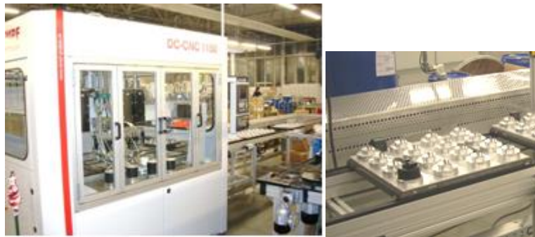
Obr. 22 Zalévací stroj (vlevo) a vozík v zakládací stanici (vpravo) (zdroj: interní materiály společnosti)
