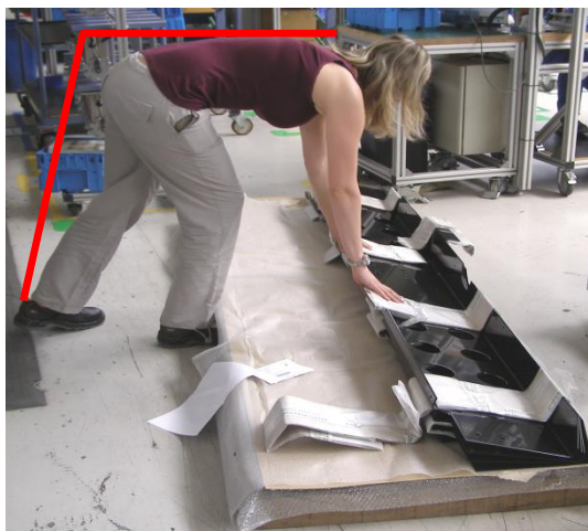
Obr. 17: Nevhodné uložení těžkých konzol pohonu (vlastní zpracování)
