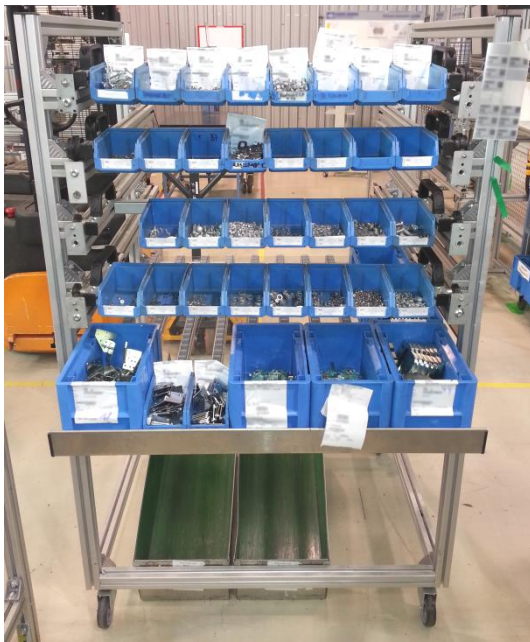
Obr. 22: Vozík se spojovacím materiálem (vlastní zpracování)
