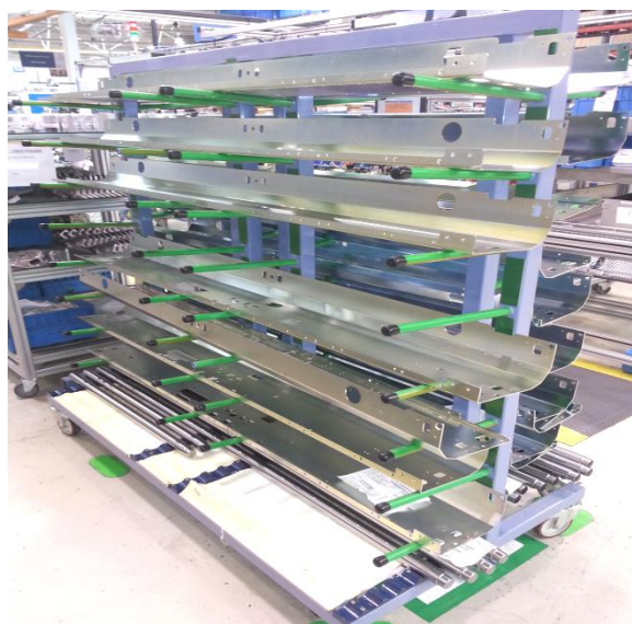
Obr. 30: Stojan s těžkými konzolami (vlastní zpracování)
