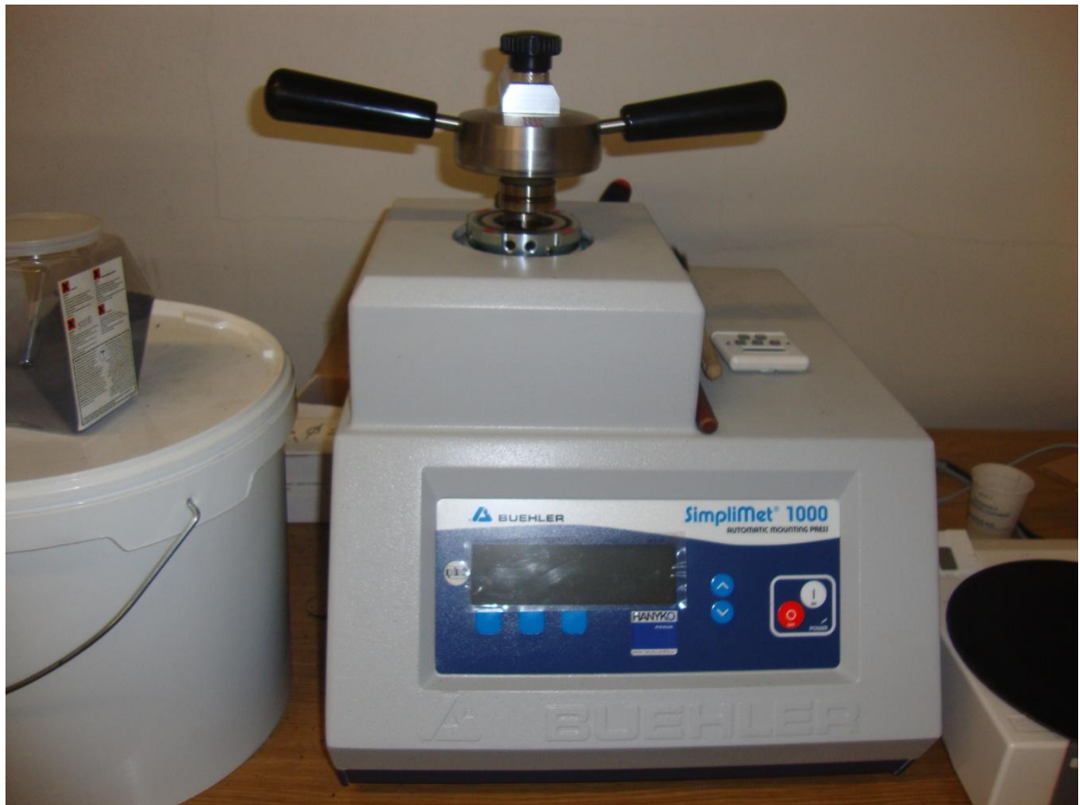
Obr. 21 Stroj na zalisování vzorků Simpli-Met 1000
