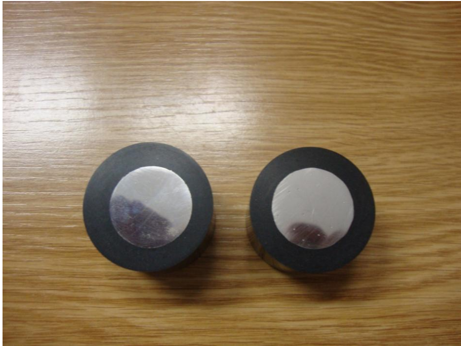
Obr. 19 Připravené vzorky po zalisování a vyleštění
