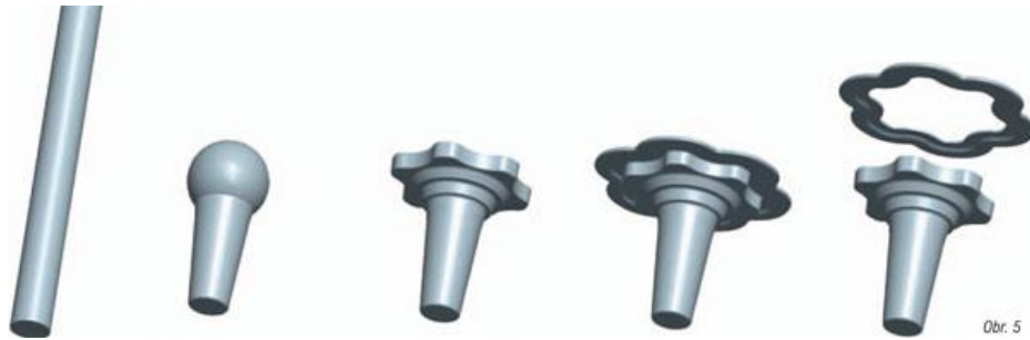
Obrázek 20 – Příklad objemového tvarování oceli (Miroslav, © 2014)
