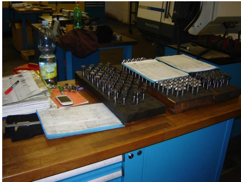
Obrázek 11 Nepřehledné uspořádání pracovního stolu (vlastní zpracování)
