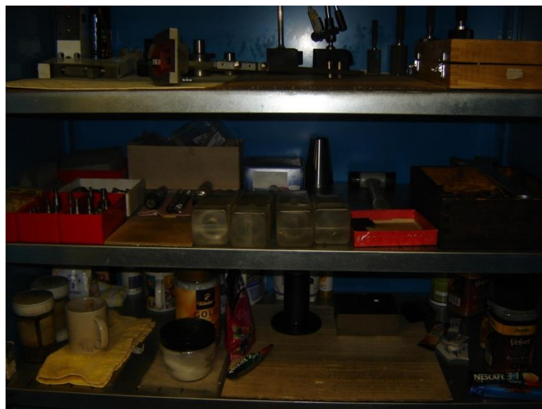
Obrázek 12 Ukládání věcí osobní potřeby a potravin společně s nástroji a měřidly (vlastní zpracování)
