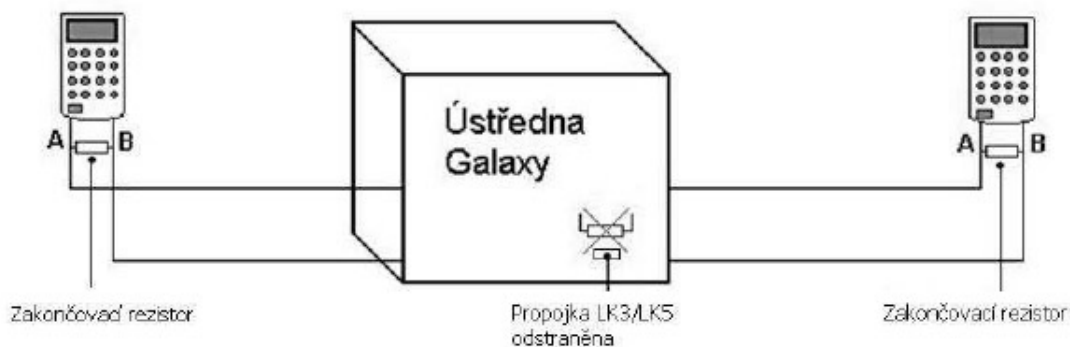
Obr. 11: Příklad dovoleného větvení datové sběrnice
