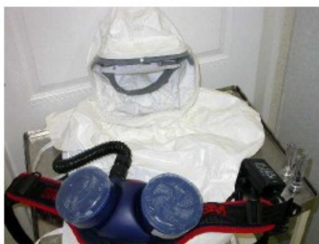
Obr. 9: Filtr-ventilační jednotka JUPITER 3M vytvářející přetlak v náhlavním díle s filtry P3 (včetně baterie pro provoz na cca 8h)
