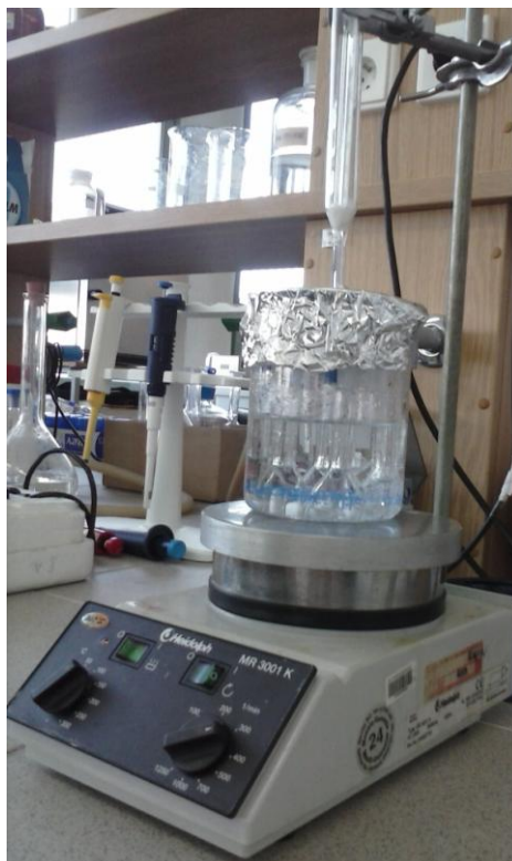
Obr. 11. Rozpuštění vzorků hyaluronanu pomocí ohřevu na magnetickém míchadle při teplotě 50 °C
