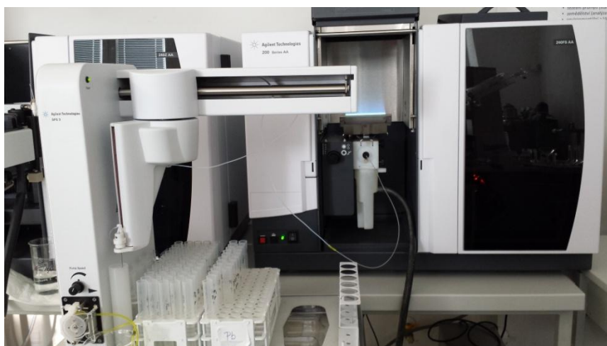
Obrázek č. 18: Atomový absorpční spektrometr FA-AAS, Agilent AAS Duo 240 FS / 24 OZ (UTB, Zlín)
