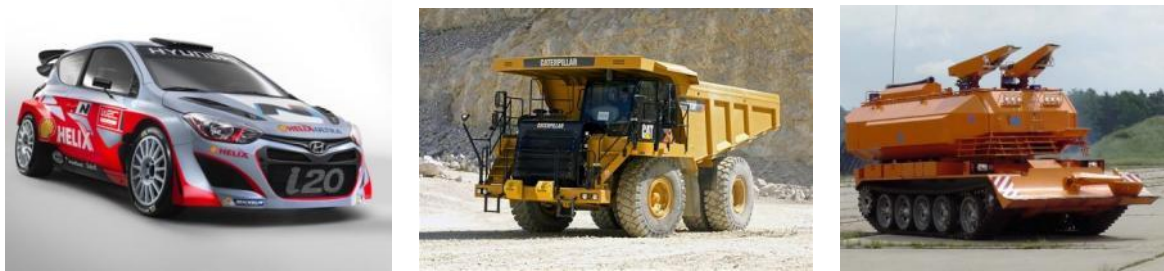
Obr. 10. Zleva Hyundai i20 (WRC rally speciál – výkon 300koní) [20], Dampr Caterpillar 775F (100tunové nákladní vozidlo) [21], Spot-55 (hasící vozidlo na pásovém podvozku) [22]
