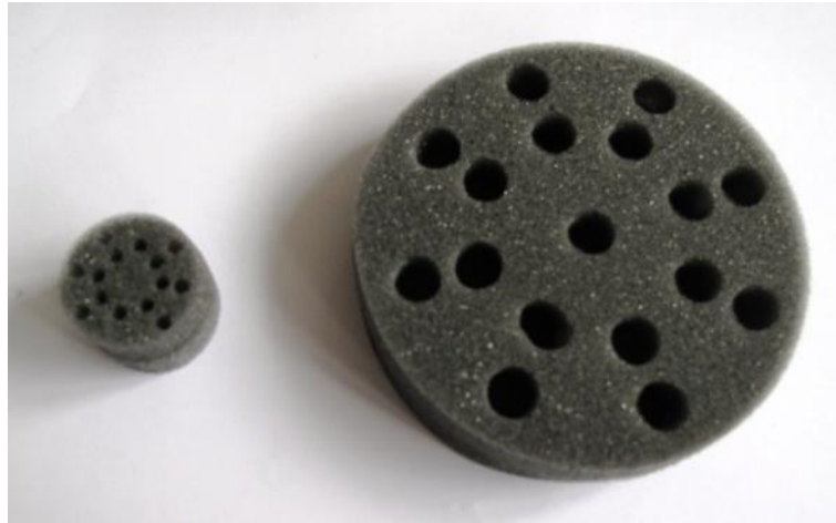
Obr. 49. Vzorky VZ1+2_17 pro měření zvukové pohltivosti PUR S3535F zleva 30 a 100 mm
