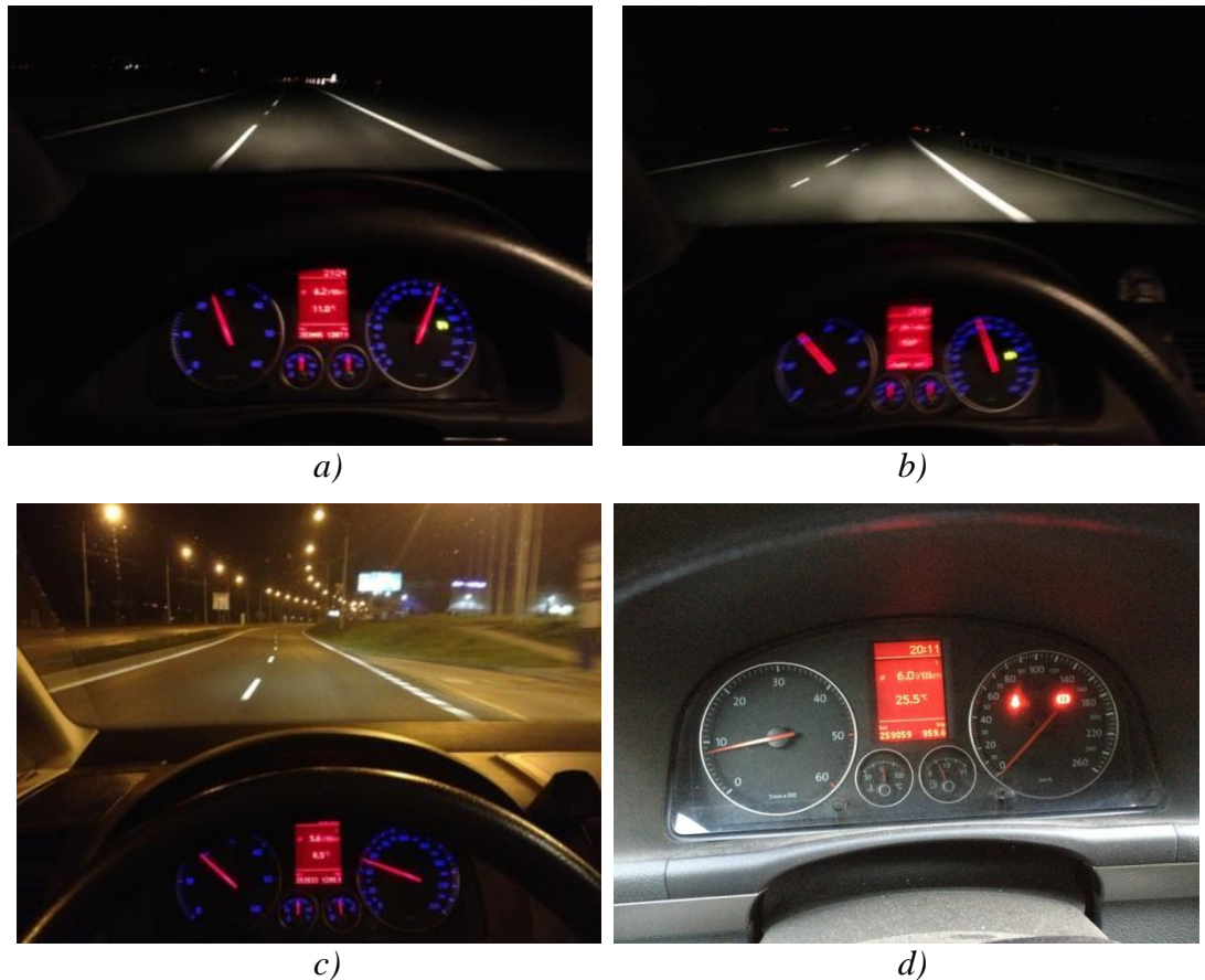
Obr. 84. Vnější podmínky na vozovce při měření frekvenční analýzy a ekvivalentní hladiny akustického tlaku; a) 130 km/h, b) 90 km/h, c) 50 km/h d) režim statického vozidla
