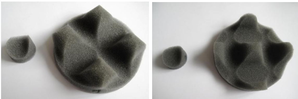
Obr. 40. Vzorky VZ3 pro měření zvukové pohltivosti PUR H3050 zleva m1V1 a m1V2
