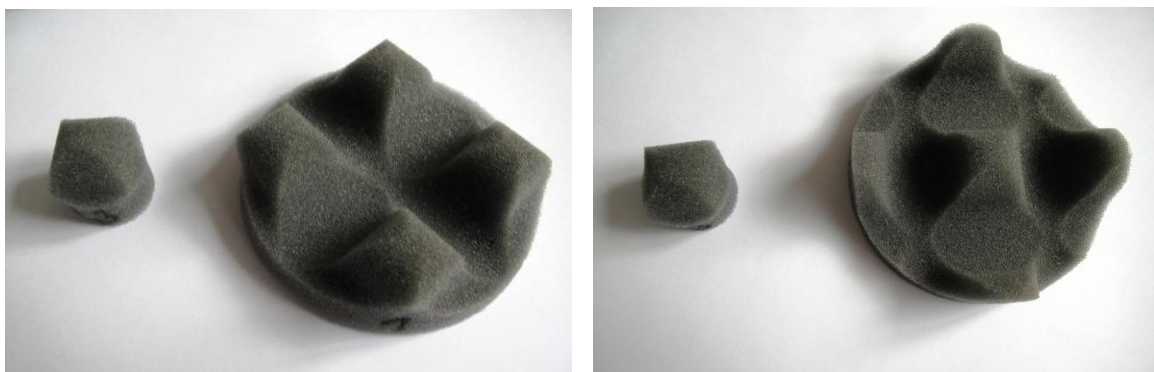
Obr. 41. Vzorky VZ3 pro měření zvukové pohltivosti PUR H3050 zleva m2V1 a m2V2
