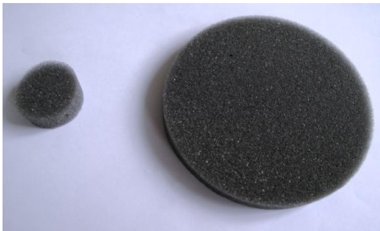
Obr. 27. Vzorky VZ1 pro měření zvukové pohltivosti PUR S3535F 30 a 100 mm
