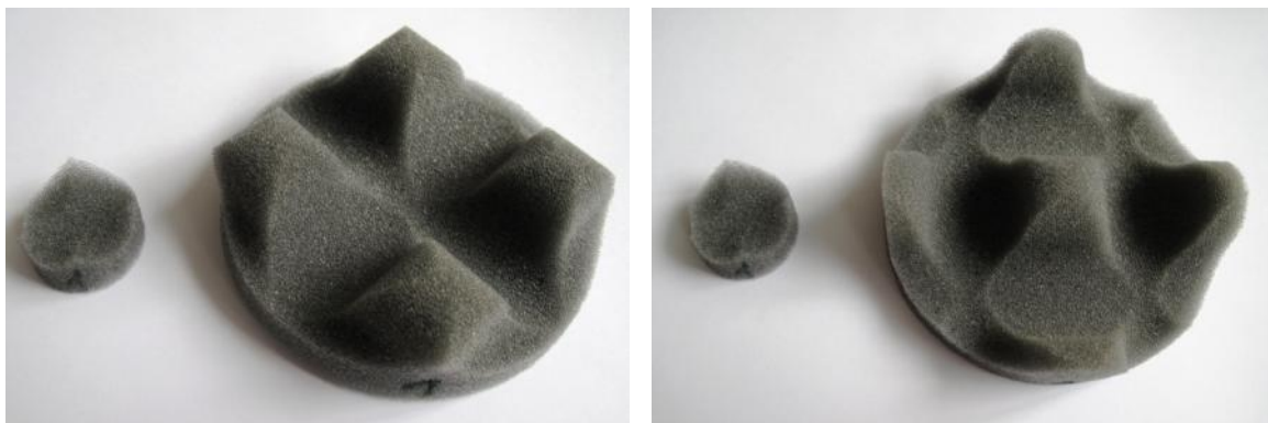
Obr. 40. Vzorky VZ3 pro měření zvukové pohltivosti PUR H3050 zleva m1V1 a m1V2
