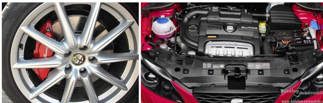
Obr. 12. Největší zdroje hluku u „běžného“ osobního automobilu (zleva pneumatika a motor vozidla)
