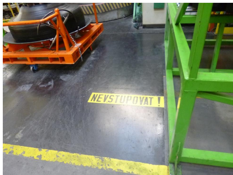
Obr. 26. Označení nebezpečného prostoru [vlastní zdroj].
