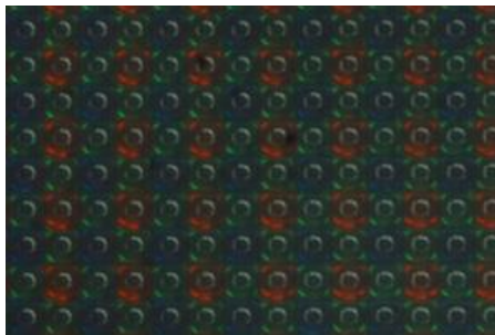
Obrázek 5 Mikroskopická fotografie reálného senzoru, kde je vidět Bayerova maska a mikroobjektivy [19]
