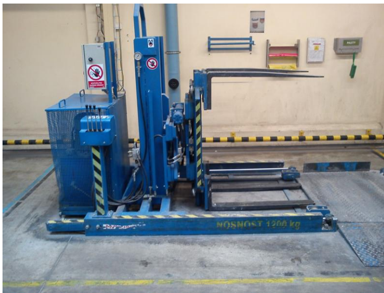
Obr: 11: Stroj na výměnu palet [23]
