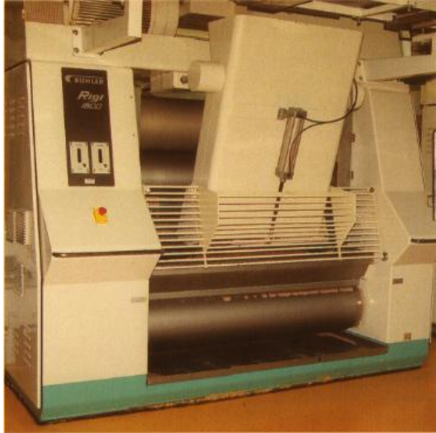
Obr. 16: Pětiválec pro zjemnění čokoládové hmoty [22]
