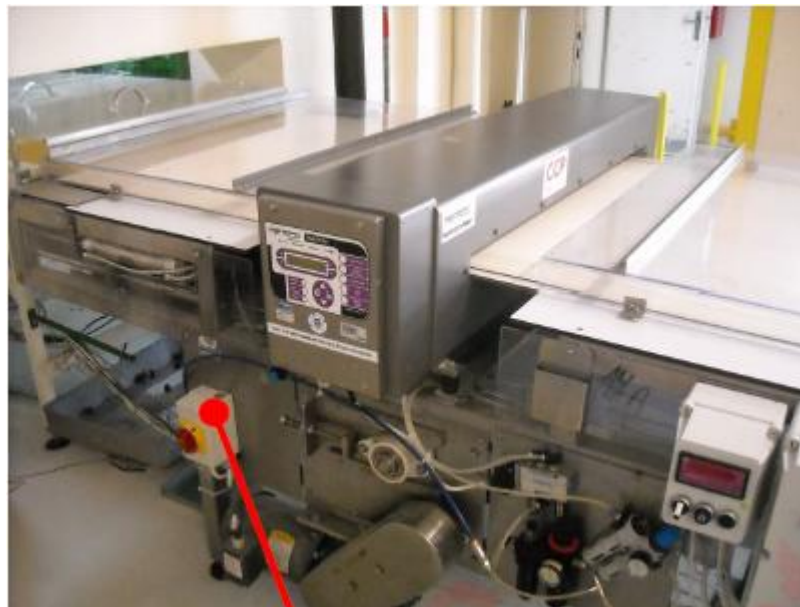
Obr. 19: Metaldetektor na výrobní lince [23]
