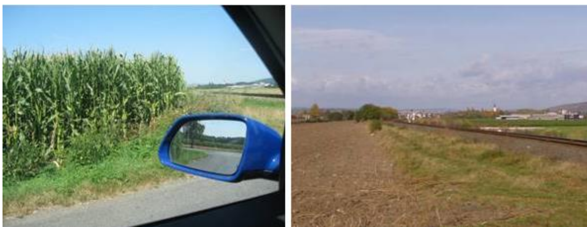
Obr. 9 Nedostatečný rozhled na železniční trať před železničním přejezdem [24]
