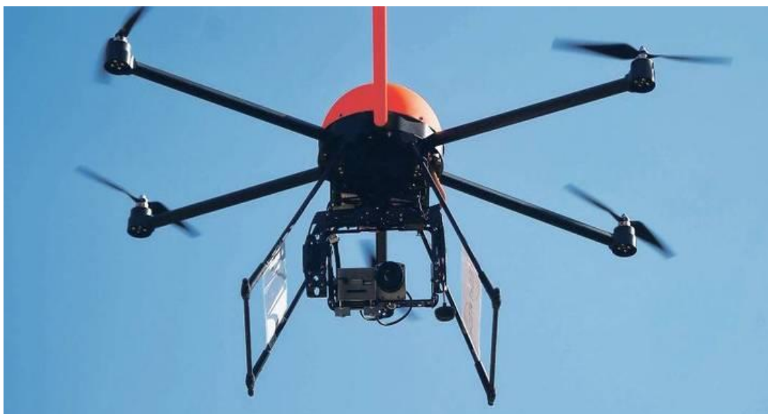
Obr. 8 Bepilotní letoun s termální kamerou [17]
