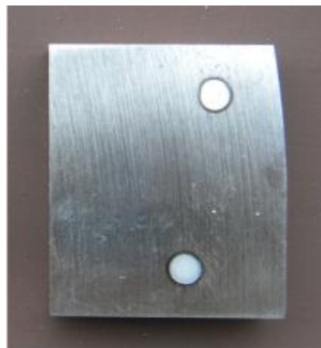
Obr. 17: Vzorek pro mikrotvrdost i metalografii
