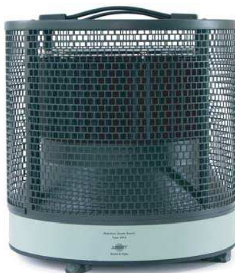
Obr. 46 – Referenční zdroj zvuku Brüel & Kjær 4204
