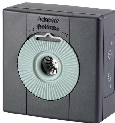
Obr. 47 – Akustický kalibrátor Brüel & Kjær typ 4231
