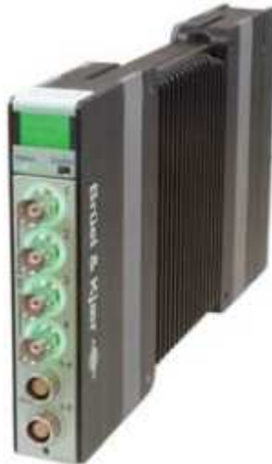
Obr. 44 – Modul Brüel & Kjær LAN-XI typ 3056
