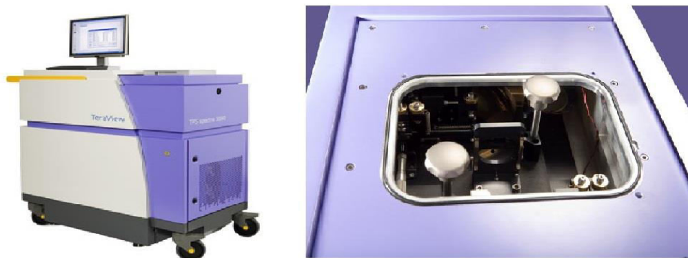
Obr. 23 Vľavo TPS Spectra 3000 [14] a vpravo komora pre vzorky [15]
