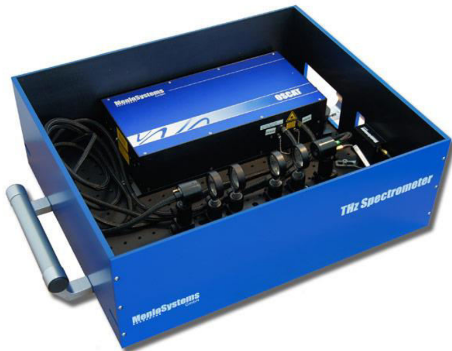
Obr. 21 Zariadenie TERA OSCAT bez podpornej ovládacej elektroniky [13]
