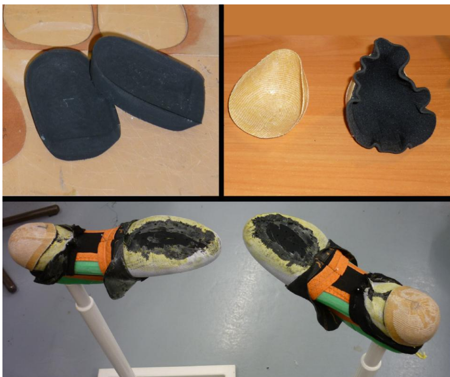
Obr. č. 33 Vybroušené podpatky, tvarované opatky a vkládání opatek při napínání
