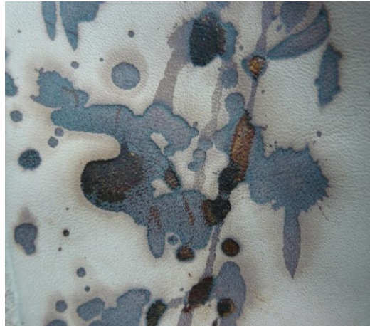
Obrázok č.15: Hydroxid sodný aplikovaný v rôznej koncentrácii roztoku na useň
