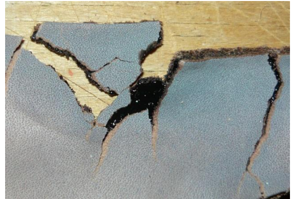
Obrázok č.16,17: Pôsobenie kyseliny na materiál, krátko po aplikovaní a po 2 týždňoch
