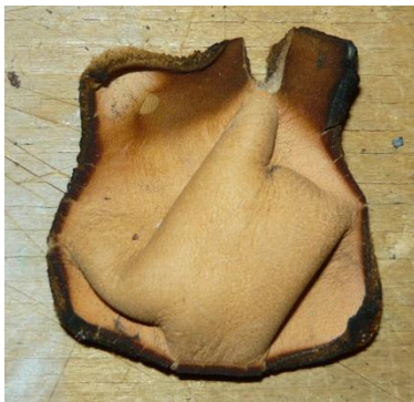
Obrázky č.12,13,14: Zdeformované vzorky usne poliate benzínom, liehom a acetónom
