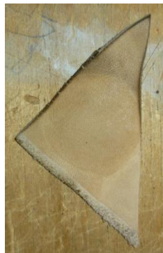
Obrázky č.12,13,14: Zdeformované vzorky usne poliate benzínom, liehom a acetónom
