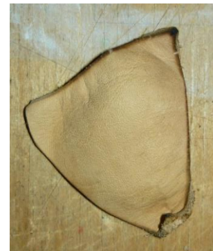
Obrázky č.12,13,14: Zdeformované vzorky usne poliate benzínom, liehom a acetónom
