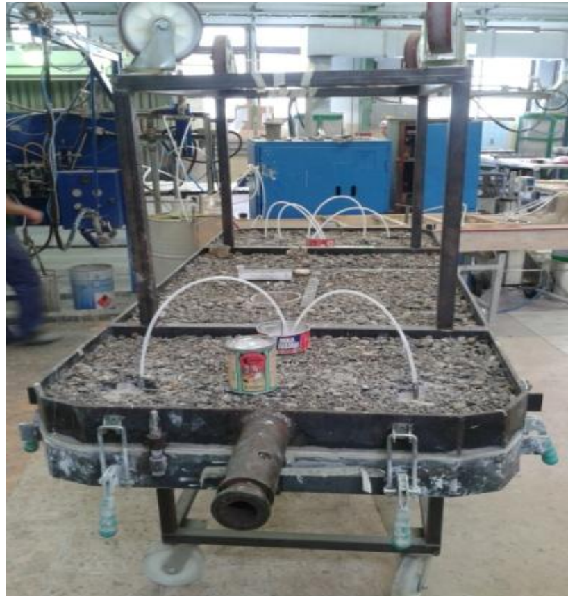
Obr. 32. Uzavřená forma s odvzdušňovacím systémem.
