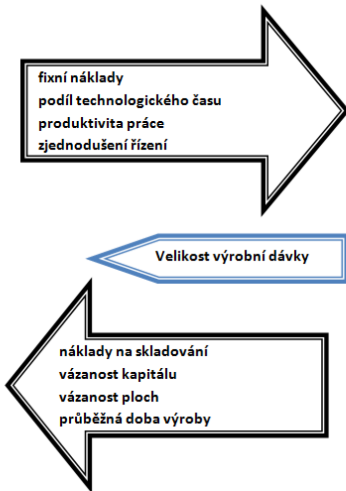
Obrázek 22 Činitelé působící na velikost výrobní dávky (Tomek, s. 144)
